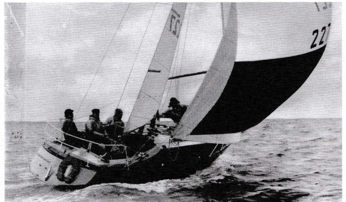
Der Listang ist eine Kooperation von Libor und Konstrukteur Feltz. Der Backdecker aus Blech war leicht, gleitfähig und seiner Zeit voraus
